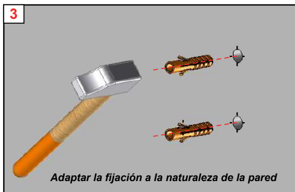
Fijación de los tornillos de Ø10mm. Kit de tornillos y tacos no incluidos.
