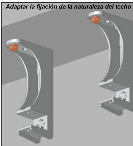
Fijación de los tornillos de  $\varnothing 10\text{mm}$ . Kit de tornillos y tacos no incluidos.
