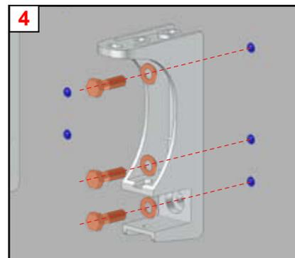
Fijación de los tornillos de  $\varnothing 10\text{mm}$ . Kit de tornillos y tacos no incluidos.
